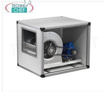
**Aspirateurs centrifuges caissonnés 2 vitesses, débit maxi 3500/2325 m<sup>3</sup>/h, V.380/3**
