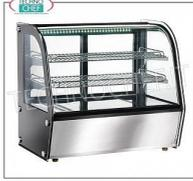
VITRINE CHAUFFANTE, ventilée, température réglable de +30° à +90°C, avec 2 étagères intermédiaires, vitre coulissante côté opérateur, éclairage, capacité 160 lt, V.230/1, Kw.1,1, dimensions extérieures mm.880x580x670h
