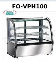
**VITRINE CHAUFFANTE, ventilée, température réglable de +30° à +90°C, avec 2 étagères intermédiaires, vitre coulissante côté opérateur, éclairage, capacité 100 lt, V.230/1, Kw.1,1, dimensions extérieures mm.710x460x670h**
