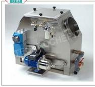
Décapeur de suie en acier inoxydable pour fours et grils à bois, CAPACITÉ 1000-2000 m<sup>3</sup>/h, V 380/3, kw 1,5, dim. mm 1150x750x950h
