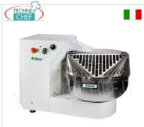
Pétrin à fourche 30 kg avec cuve 35 lt, 1 vitesse, TRIPHASÉ, V.400/3, Kw.0,75, Poids 140 Kg, dim.mm.1000x650x610h
