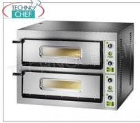
Four à pizza électrique à deux chambres de 720 x 1080 x 140 h mm, avec porte vitrée, surface de cuisson en réfractaire, 4 thermostats réglables pour le fond et le dessus, température de +50 °C à +500 °C, poids 200 kg, V.400/3+N, puissance 18 kW, dimensions extérieures 1010 x 1210 x 750 h mm.
