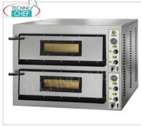
Four à pizza électrique à deux chambres de 720 x 1080 x 140 h mm, avec porte vitrée, surface de cuisson en réfractaire, 4 thermostats réglables pour le fond et le dessus, température de +50 °C à +500 °C, poids 200 kg, V.400/3+N, puissance 18 kW, dimensions extérieures 1010 x 1210 x 750 h mm.
