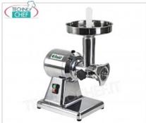
Hachoir 'TYPE 12' avec BOUCHE diamètre 52 mm, PRODUCTION HORAIRES 100-160 kg, groupe de broyage en ALUMINIUM - AMOVIBLE, V. 230/1, Kw 0,75, dim. mm 250x400x500h
