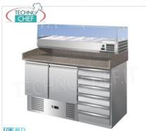
**COMPTOIR RÉFRIGÉRÉ POUR PIZZA, 2 PORTES, 6 TIROIRS**, Vitrine réfrigérée de 380 mm de profondeur, capacité 4 bacs GN1/3 (mm 325x175) + 1 GN1/2 (mm 325x265), Temp. +2°/+8°C, Classe E, Gaz R600a, V.230/1, Kw.0.235, Poids Kg. 288, dim.mm.1420x700x1455h
