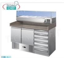
**COMPTOIR RÉFRIGÉRÉ POUR PIZZA, 2 PORTES, 6 TIROIRS**, Vitrine réfrigérée de 330 mm de profondeur, capacité 6 bacs GN 1/4 (265x162 mm), Temp. +2°/+8°C, Ventilé, **ÉCOLOGIQUE** en Classe E, Gaz R600a, V.230/1, Kw.0.235, Poids Kg. 280, dim.mm.1420x700x1455h
