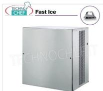
**Machine à glaçons FAST ICE, rendement max. 400 kg/24h, cubes verticaux, à combiner avec un bac de stockage de glace, refroidissement par air, V.230/1, Kw 3,00, poids 113 kg, dim.mm.770x550x805h**
