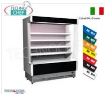
**VITRINE RÉFRIGÉRÉE MURALE**, marque **TECNODOM**, série **VULCANO 60**, avec 4 clayettes réglables, éclairage supérieur au néon, température +3°/+5°C, prédisposition pour **GROUPE FRIGORIFIQUE À DISTANCE**, V.230/1, Kw.0,129, Poids 255 Kg, dim.mm.1955x602x1970h
