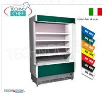
**VITRINE RÉFRIGÉRÉE MURALE**, marque **TECNODOM**, série **VULCANO 60**, avec **4 clayettes réglables**, éclairage supérieur au néon, température **+3°/+5°C**, prédisposition pour **GROUPE FRIGORIFIQUE À DISTANCE, V.230/1, kW 1 595, poids 170 kg, dimensions mm 1 330 x 602 x 1 970 h**
