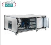
**UNITÉ DE CONTRÔLE D'ASPIRATION, DE FILTRATION ET DE DÉSODORISATION avec 36 CYLINDRES de charbon actif végétal, préfiltre à poches et 2 filtres synthétiques, débit max. 12000 m/cu/h, 1100 tr/min, V.400/3, Kw.5,5, Poids 420 Kg, dim.mm.2600x1280x1280h**
