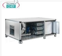
**UNITÉ DE CONTRÔLE D'ASPIRATION, DE FILTRATION ET DE DÉSODORISATION avec 28 CYLINDRES de charbon actif végétal, préfiltre à poches et 2 filtres synthétiques, débit max 9000 m/cu/h, 900 tr/min, V.400/3, Kw.3,00, Poids 360 Kg, dim.mm.2600x1280x980h**
