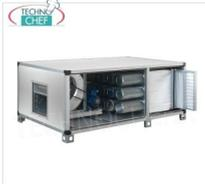
**UNITÉ DE CONTRÔLE D'ASPIRATION, DE FILTRATION ET DE DÉSODORISATION avec 23 CYLINDRES de charbon actif végétal, préfiltre à poches et 2 filtres synthétiques, débit max. 7500 m/cu/h, 1120 tr/min, V.400/3, Kw.3,00, Poids 330 Kg, dim.mm.2400x1590x800h**
