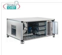
**UNITÉ DE CONTRÔLE D'ASPIRATION, DE FILTRATION ET DE DÉSODORISATION avec 9 CYLINDRES de charbon actif végétal, préfiltres électrostatiques et synthétiques, débit max. 3000 m<sup>3</sup>/h, 1600 tr/min, V.400/3, Kw.1,5, Poids 155 Kg, dim.mm.1700x670x670h**
