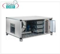
**UNITÉ DE CONTRÔLE D'ASPIRATION, DE FILTRATION ET DE DÉSODORISATION avec 18 CYLINDRES de charbon actif végétal, préfiltres électrostatiques et synthétiques, débit max. 6000 m<sup>3</sup>/cu/h, 1200 tr/min, V.400/3, Kw.2.2, Poids 285 Kg, dim.mm.1800x1280x800h**
