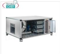
**UNITÉ DE CONTRÔLE D'ASPIRATION, DE FILTRATION ET DE DÉSODORISATION avec 28 CYLINDRES de charbon actif végétal, préfiltres électrostatiques et synthétiques, débit max. 9000 m<sup>3</sup>/cu/h, 900 tr/min, V.400/3, Kw.3,00, Poids 370 Kg, dim.mm.2100x1280x980h**
