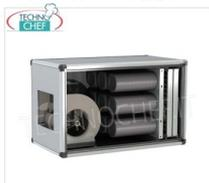
**UNITÉ DE CONTRÔLE D'ASPIRATION, DE FILTRATION ET DE DÉSODORISATION avec 5 CYLINDRES de charbon actif végétal et 2 préfiltres synthétiques, débit max. 1500 m<sup>3</sup>/cu/h, 1400 tr/min, V.230/1, Kw.0,53, Poids 100 Kg, dim.mm.960x670x440h**
