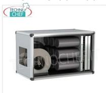
**UNITÉ DE CONTRÔLE D'ASPIRATION, DE FILTRATION ET DE DÉSODORISATION avec 9 CYLINDRES de charbon actif végétal et 2 préfiltres synthétiques, débit max. 3000 m<sup>3</sup>/cu/h, 1400 tr/min, V.230/1, Kw.0,55, Poids 115 Kg, dim.mm.1200x670x750h**
