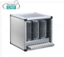
**Groupe de Filtration et de Désodorisation** composé de **n.1 préfiltre en microfibre de verre auto-extinguible** et **n.5 cylindres de Charbon Actif**, débit max **1500 m<sup>3</sup>/cu/heure**, Poids **50 Kg**, dim.mm.**700x400x700h**
