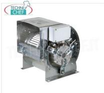
**Ventilateur centrifuge à double ouïe avec moteur directement couplé à la roue à aubes avant, pour installation dans un caisson d'extraction, 1 VITESSE, 4 pôles, 1300 RPM, débit max. 2500 m3/h, V.230/1, Kw.0,42, dim.mm.378x298x390h**
