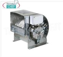
Ventilateur centrifuge à double ouïe avec moteur directement couplé à la roue à aubes avant, pour installation dans un caisson d'extraction, 1 VITESSE, 6 pôles, 970 RPM, débit max. 1500 m<sup>3</sup>/h, V.230/1, Kw.0,25, dim.mm.378x232x390h
