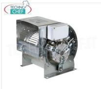
**Ventilateur centrifuge à double ouïe avec moteur directement couplé à la roue à aubes avant, pour installation dans un caisson d'extraction, 1 VITESSE, 4 pôles, 1260 RPM, débit max. 2800 m3/h, V.230/1, Kw.0,55, dim.mm.429x265x444h**
