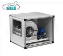
**ASPIRATEUR CENTRIFUGE AVEC TRANSMISSION PAR COURROIES ET POULIES, panneaux en ACIER INOXYDABLE, 2 VITESSES, débit max. 2500/1673 m<sup>3</sup>/h, tr/min 1450/970, db 67/52, V.380/3, Kw.0,81/0,28, Poids 41 Kg, dim.mm.800x600x600h**
