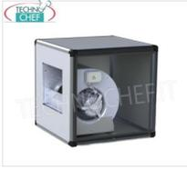
**ASPIRATEUR EN BOÎTE avec VENTILATEUR CENTRIFUGE avec MOTEUR DIRECTEMENT COUPLÉ à la ROUE, panneaux en ACIER INOXYDABLE, débit max. 4 600 m<sup>3</sup>/h, 940 tr/min, 1 vitesse, db 52, V.230/1, Kw.0,736, Poids 75 Kg, dim.mm.750x750x750h**
