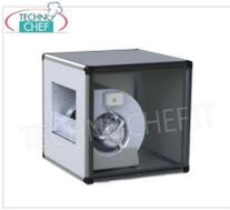
**CENTRIFUGE avec MOTEUR DIRECTEMENT COUPLÉ à la ROUE, panneaux en ACIER INOXYDABLE, débit max. 1 800 m<sup>3</sup>/h, 1 400 tr/min, 1 vitesse, db 52, V.230/1, Kw.0,42, Poids 28 Kg, dim.mm.500x500x500h**
