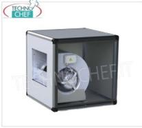
**ASPIRATEUR EN BOÎTE avec VENTILATEUR CENTRIFUGE avec MOTEUR DIRECTEMENT COUPLÉ à la ROUE, panneaux en ACIER INOXYDABLE, débit max. 2 800 m<sup>3</sup>/h, 1 260 tr/min, 1 vitesse, db 49, V.230/1, Kw.0,56, Poids 35 kg, dim.mm.600x600x600h**
