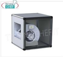
**ASPIRATEUR EN BOÎTE avec VENTILATEUR CENTRIFUGE avec MOTEUR DIRECTEMENT COUPLÉ à la ROUE, panneaux en ACIER INOXYDABLE, débit max. 2 500 m<sup>3</sup>/h, 1 300 tr/min, 1 vitesse, db 53, V.230/1, Kw.0,42, Poids 33 Kg, dim.mm.600x600x600h**
