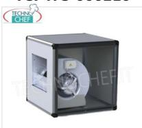
**ASPIRATEUR EN BOÎTE avec VENTILATEUR CENTRIFUGE avec MOTEUR DIRECTEMENT COUPLÉ à la ROUE, panneaux en ACIER INOXYDABLE, débit max. 4 000 m<sup>3</sup>/h, 940 tr/min, 1 vitesse, db 52, V.230/1, Kw.0,57, Poids 67 Kg, dim.mm.750x750x750h**
