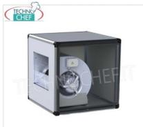
**ASPIRATEUR EN BOÎTE avec VENTILATEUR CENTRIFUGE avec MOTEUR DIRECTEMENT COUPLÉ à la ROUE, panneaux en ACIER INOXYDABLE, débit max 800 m<sup>3</sup>/cu/heure, 970 tr/min, 1 vitesse, db 41, V.230/1, Kw. 0,087, poids 24 kg, dim.mm.500x500x500h**
