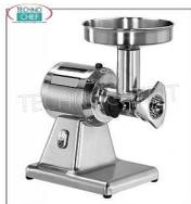
Hachoir à viande 'TYPE 12' avec bouche de chargement diamètre 52 mm, DÉBIT 160 Kg/h, groupe de hachage à viande AMOVIBLE en acier inoxydable, monophasé V. 230/1, Kw 0,75, dim. mm 400x250x500h
